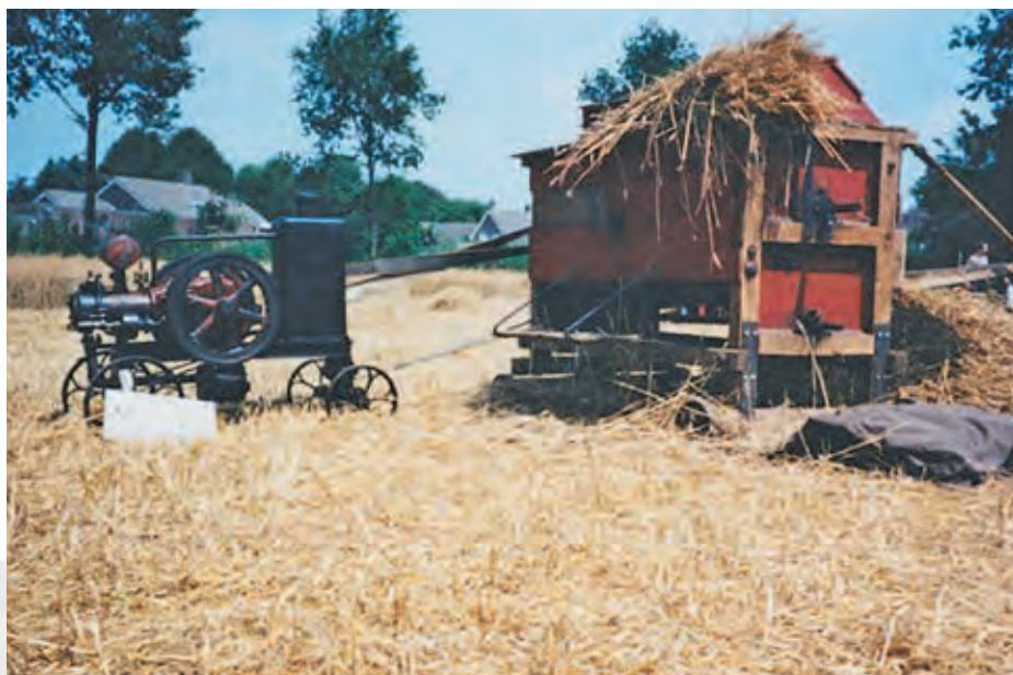
Stationaire motor in bedrijf. Drijft een dorsmachine aan.
