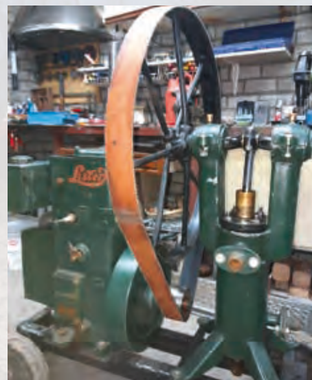
Lister machine waarbij de poelie met een riem een waterpomp aandrijft.
